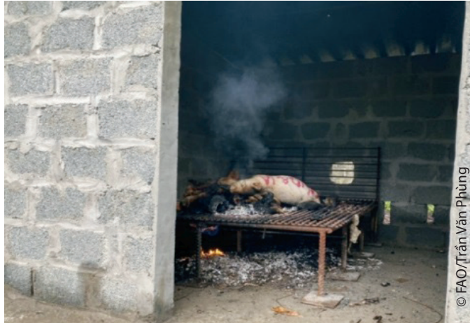
Hình 37. Giàn thiêu lợn chết sử dụng khí biogas
